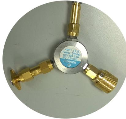
Figura 17: Dispositivo da misurare.
