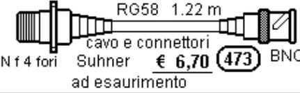
RG58 1.22 m<br>cavo e connettori N f 4 fori Suhner € 6,70 <b>473</b> BNC ad esaurimento                     |
